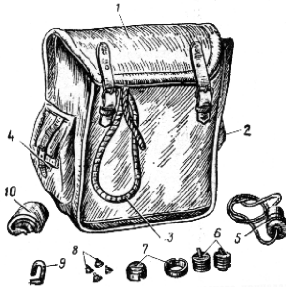
Мал. 26. Чохол для перенесення оптичного прицілу: 1-чохол; 2-кишень для зимового пристрою освітлення сітки; 3-шнурок; 4-кишень для серветки; 5- зимовий пристрій освітлення сітки; 6-батарейки; 7-світлофільтри; 8-лампочки; 9-ключ-викрутка; 10-серветка
