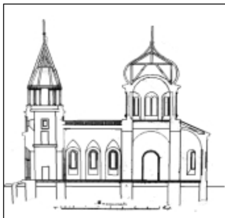
Поздовжній переріз церкви. Проектний кресленик 1855 р.
