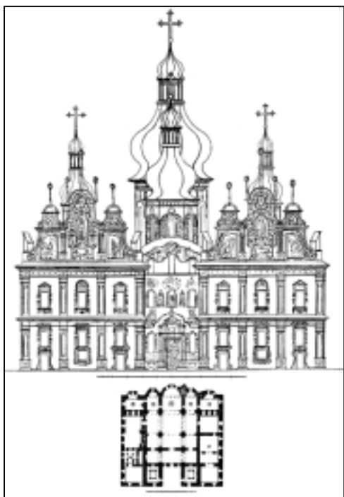
Західний фасад і план собору за обмірами 1840-х років
