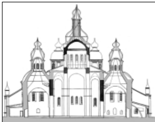
Поперечний переріз собору. За І.Моргилевським
