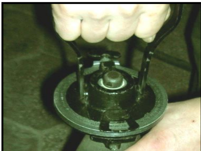
Рисунок 4.11 – Установка ключа ЗИ36 на підричник
