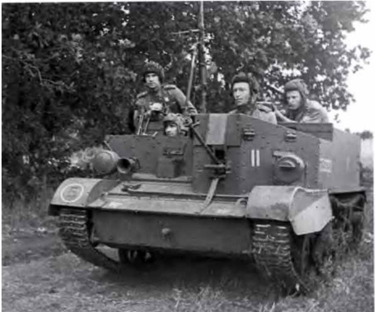
Бійці одного з розвідувальних підрозділів Червоної Армії на британському бронетранспортері Universal Carrier (у модифікації Брен Carrier, тобто «транспортёр кулемета Брен», однак на місці кулемета встановлено протитанкову рушницю Дегтярьова, а кулемет Брен встановлений на броні, його ствол піднятий вгору) розвідують передній край оборони противника (Орловсько-Курський напрям, липень 1943 року). Легкий багатоцільовий бронетранспортёр Universal Carrier (англ. «універсальний транспортёр») був основним бронетранспортером Великобританії в Другій світовій війні і використовувався в якості транспорту для піхотних підрозділів, носія озброєнь, подвозу боєприпасів, артилерійського тягача і розвідувальної машини. Після війни залишався на озброєнні Великобританії аж до 1950-х років і використовувався в Корейській війні.
