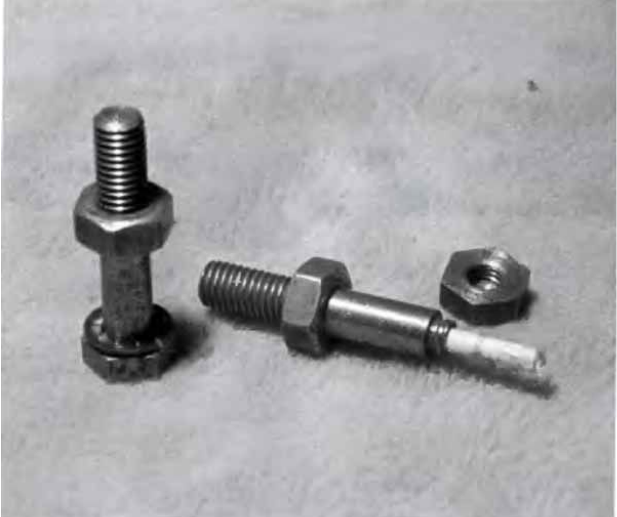
Контейнер-схованка для агентурного зв'язку, виконана у вигляді болта, у внутрішній порожнині якого заховане повідомлення. Шестигранна головка болта є кришкою контейнера (Франція, 1966 рік).
