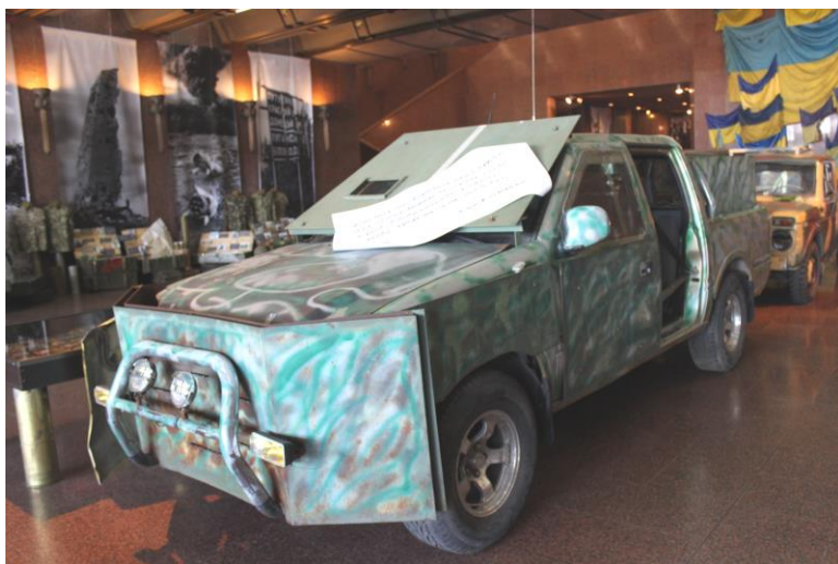
Фото П.4. Переобладнаний бійцями батальйону “Азов” “цивільний” джип у броньований
