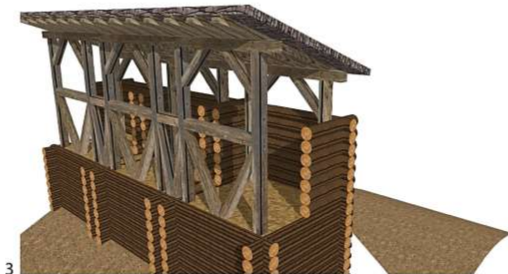
Рис. Г.2. Городище Добростани (заповнені землею городні з дахом над бойовою галереєю): переріз оборонної лінії (1); реконструкція оборонної лінії (2) і гіпотетична реконструкція оборонної галереї (3). [Креслення виготовлені автором]
