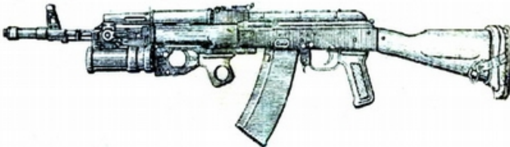
Мал. 3. Загальний вигляд гранатомета, приєднаного до автомата АК-74
