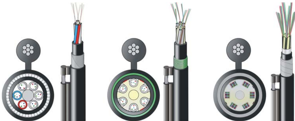
Рисунок 3.6 Конструкція самонесучого кабелю
