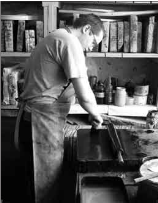
Друкарська літографська фарба викладається тонким шаром за допомогою шпателя на розкатний камінь і розкотується валом до появи рівномірного «оксамитового» відлипу.
