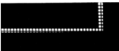
При натягненні сітки напрям нитки не повинен співпадати зі стороною рами. Кут у 15-20^\circ дасть змогу точніше і охайніше друкувати тонкі лінії та дрібні деталі
