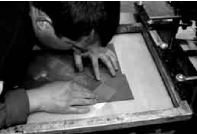
При багатокольоровому друкуванні за допомогою спеціальних механізмів у двох координатах здійснюється точная приводка, яка контролюється через прозору сітку по відбитку попереднього кольору, який лежить у постійних упорах. Велику поміч особливо при кольоровому друку надає вакуумний прижим паперу.
