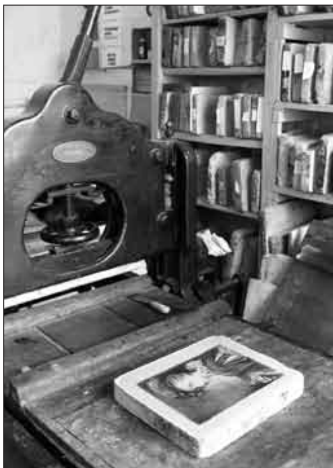
Реберний літографський друкарський верстат тепер застосовується тільки у жудожньому друку.
