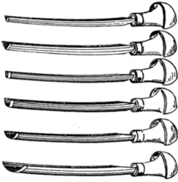
Інструменти для лінориту мають вигляд стомісток різної форми: напівкруглих, кутових які різняться шириною леза та насаджених у ручки як і в граверних різцях інших видів.
