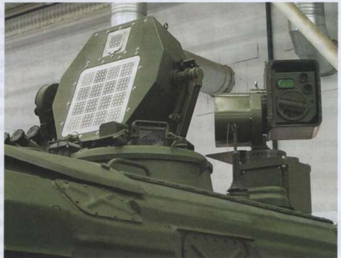
► Antena radaru Rokacz-AS i system optycznoelektroniczny na dachu wieży ZSU-23-4MA3.
