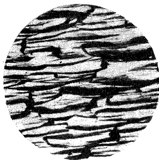
Рис. 129. Фігури травлення на площині, близькій до (110) германію ( \times 200 ).
