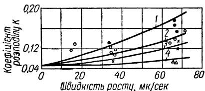
Рис. 66. Експериментальна залежність коефіцієнта розподілу галію (акцептор) у германію від швидкості росту і обертання:
