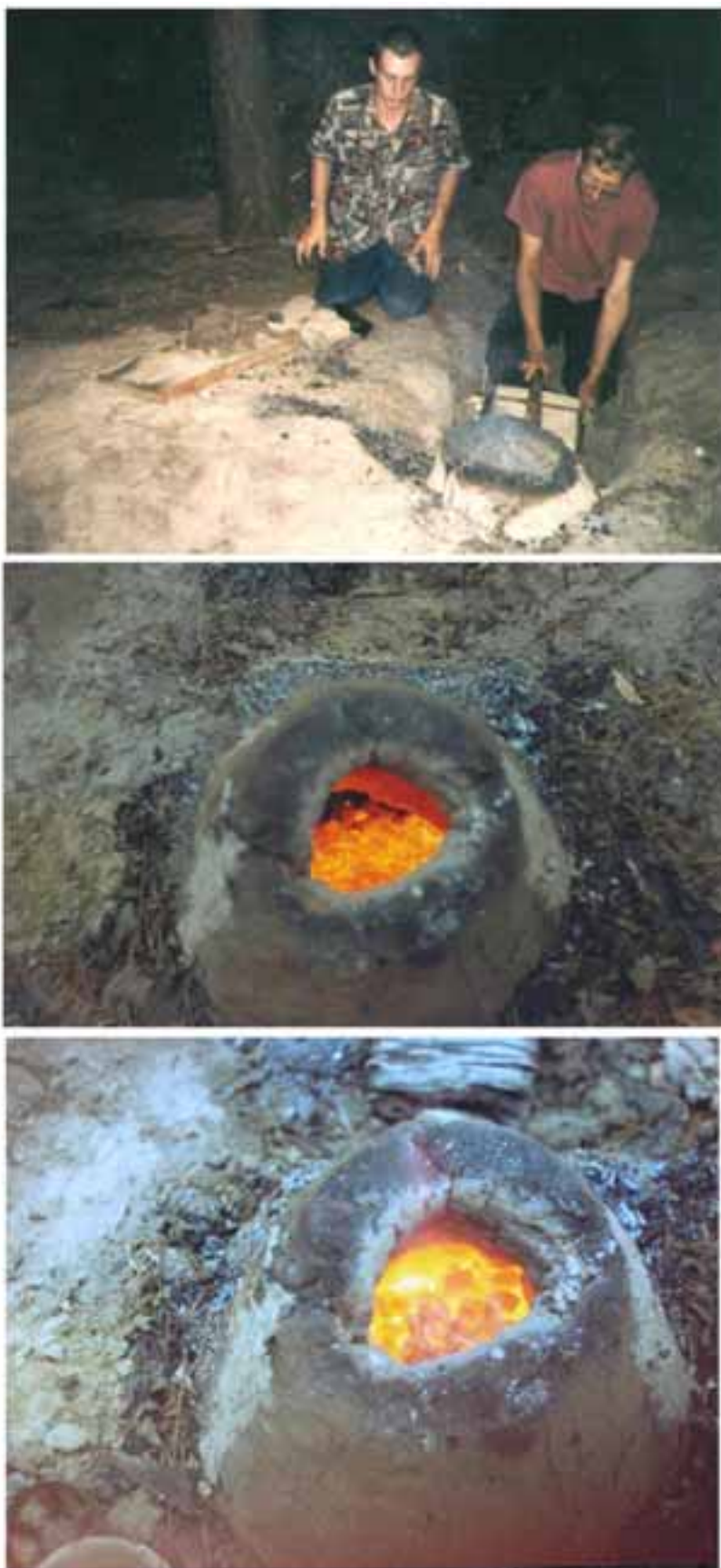
Рис. 31. Модель металургійного горна в ході експерименту з отримання кричного заліза та горно на різних етапах розігріву шихти на Ходосівському експериментальному майданчику.
