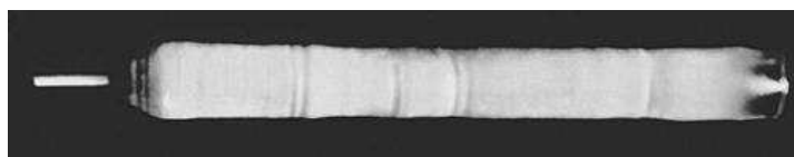
Рис. 2. Монокристалічна «буля» рубіну (довжина 20 см). Форма надана в процесі вирощування.
