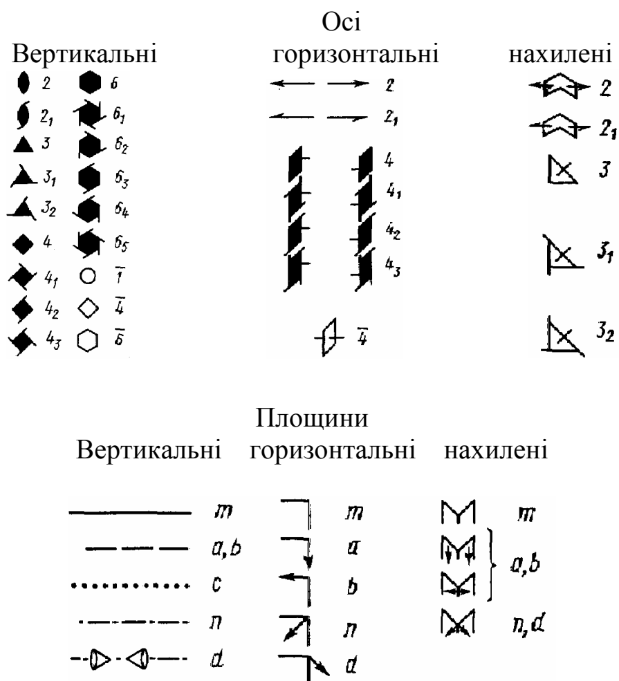
Рис. 62. Міжнародні позначення елементів симетрії структур
