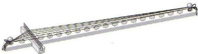
*Рис. 41. Розміщення ниток основи перед початком роботи на верстаті*
