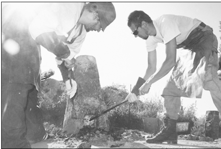
Рис. 2. Виготовлення криці в моделі давньоруського металургійного горна ( Шатов А., Матяш Г. )
