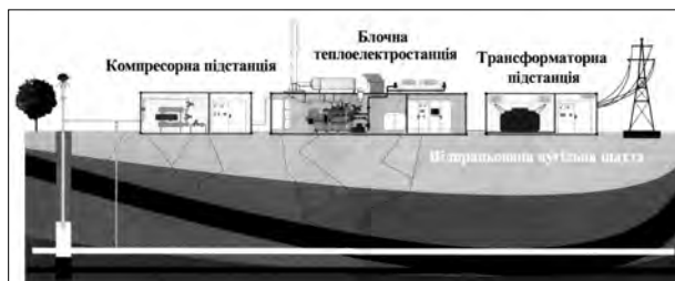
Рис. Схема установки для використання шахтного метану (IVG e.V.).
