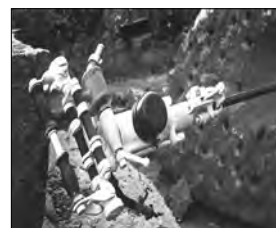
Перфоратор вітчизняної конструкції ПП-50В1.
