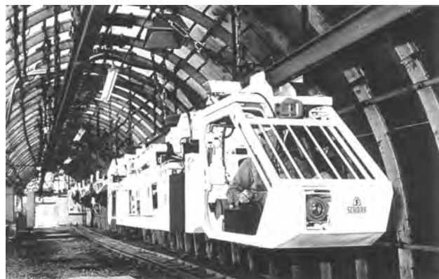
Монорейкова дорога фірми „DBT” (Deutsche Bergbau Technik).
