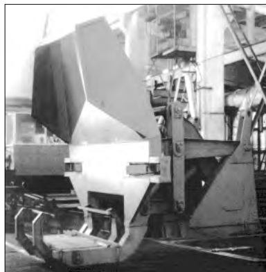
Боковий перекидач для розвантаження шахтних вагонеток усіх типорозмірів в автомобільний транспорт Київського дослідницько-експериментального заводу "Вугілля".
