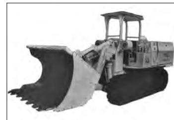
Підземна навантажувальна машина ківшева типу МПКТ. З гусеничною ходовою частиною.
