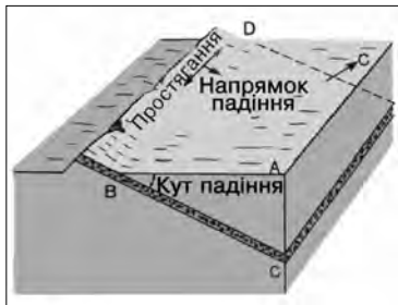
Рис. Схема, яка ілюструє падіння і простягання пласта. Кут ABC – кут падіння, BD – горизонтальна лінія, яка відповідає напрямку простягання. Напрямок падіння перпендикулярний напрямку простягання.
