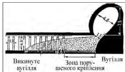
Рис. Схема раптового викиду вугілля та газу.
